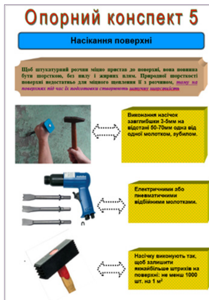
Рис.5. Опорні конспекти до уроку за темою: «Підготовка бетонної поверхні під обштукатурювання вручну та із застосуванням ручних механізованих інструментів»
